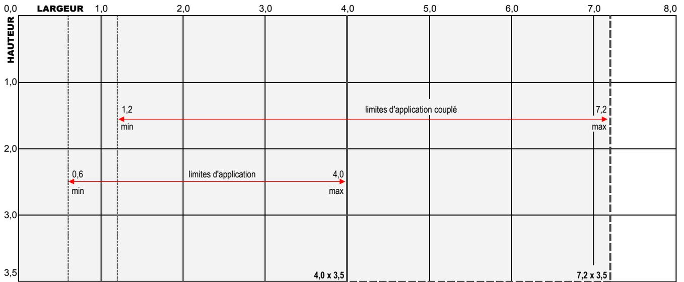
largeur max.: 4,0m (couplé: 7,2m) - hauteur max.: 3,5m
