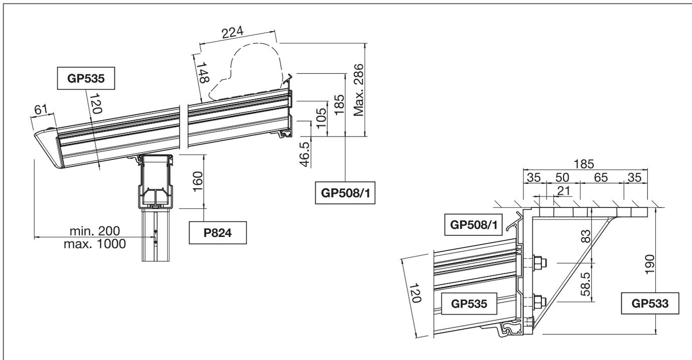
**Le profilé de finition pour façade doit être fixé sur des entretoises pour un montage sur une isolation périphérique (tube renforcé PS311).**
